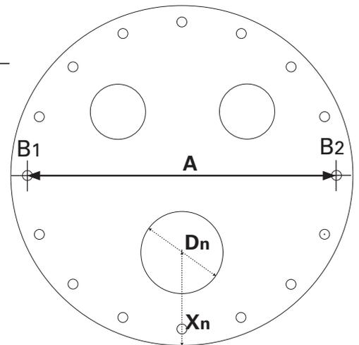
*Bei Wünschen zu Löchern bitte möglichst auch die Position mit D und X bemaßen – die Löcher werden dann möglichst weit voneinander entfernt zueinander angeordnet.*
