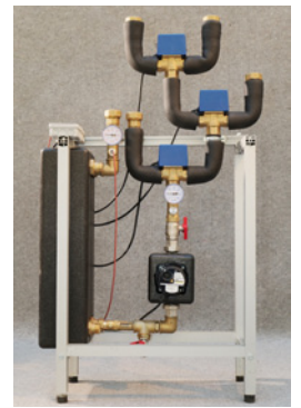
Einbindung über einen Wärmetauscher.
